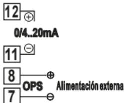
**Bornes 11-12:** salida continua en mA configurable desde parámetros como comando (par. *c.oubt*) o retransmisión del proceso-setpoint (par. *rEtr*).
