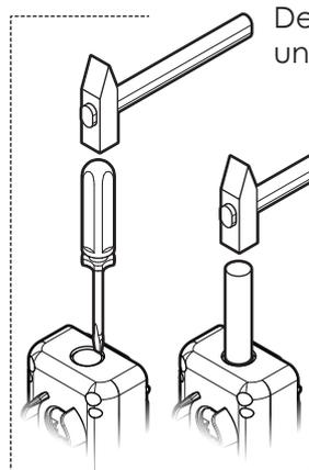
Debilita el golpe en varios puntos del perímetro con un destornillador plano y un martillo.
